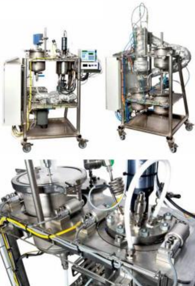
Saumond heeft de laboschaal-installaties gebouwd voor de verwijdering van brandvertrager (a) in zij-aanzicht, (b) in bovenaanzicht en (c) voor de pyrolyse. (Beeld: Saumond)
